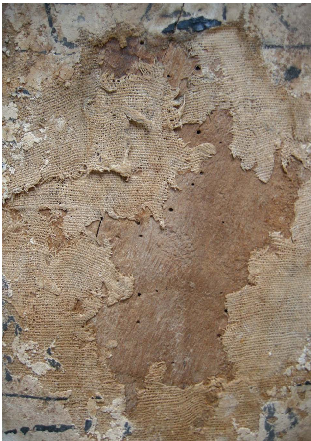
Fig. 5 • La même zone après consolidation, remise en forme et collage des textiles. © W. Boudé
