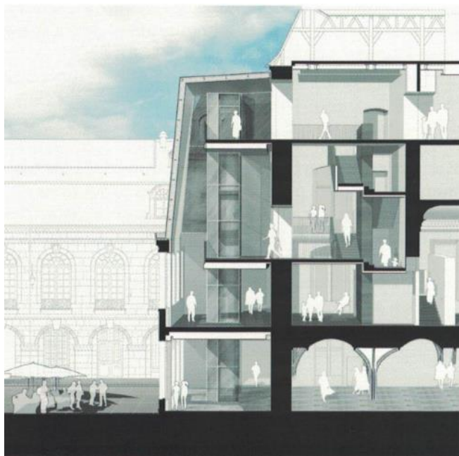
Fig. 2 Coupe de l'extension et de l'escalier du premier parcours, Avant-projet détaillé des Ateliers Lion, architectes urbanistes, juillet 2007.
