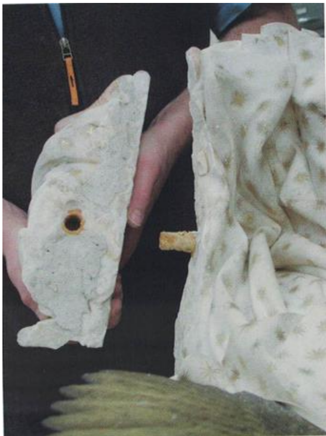
Fig. 12 Ange du tombeau de Philippe le Hardi : gougeon métallique oxydé, 2003.
